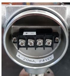
Morsettiera ZT-100 (alimentazione loop a 2 fili)
