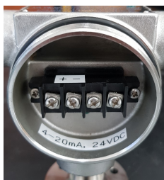
Bornier de câblage ZT-100 (alimentation par boucle 2 fils)
